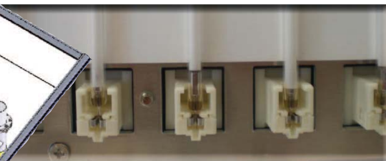
Vista interna do monitor LCD com capilares de Hg
