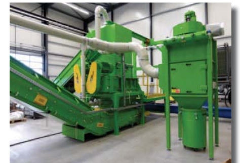
Vorzerkleinerung und Staubabsaugung
